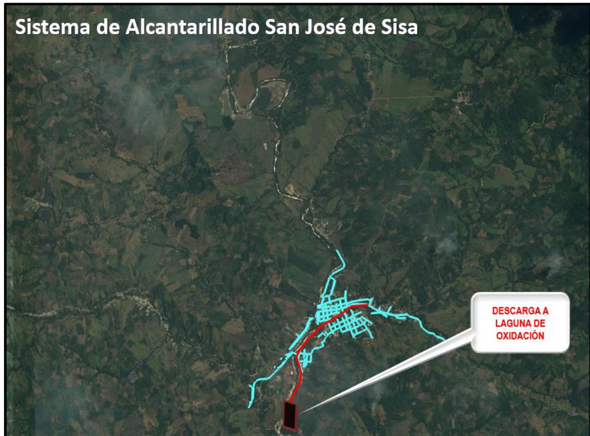
Imagen N° 64: Esquema del sistema del sistema de alcantarillado – San José de Sisa
