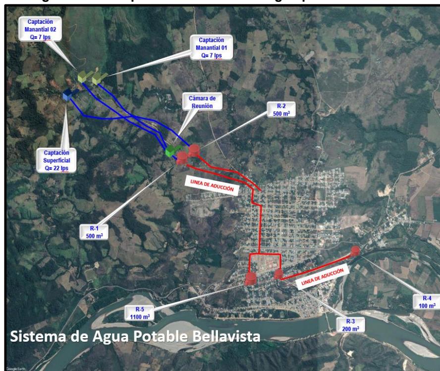
Imagen N° 70: Esquema del sistema de agua potable – Bellavista
